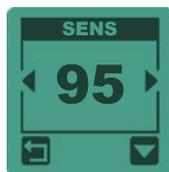
Determina el nivel de sensibilidad del dispositivo de 0 a 99.
