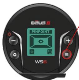
Acceda a la pantalla PINPOINT, Pulse 2 segundos
