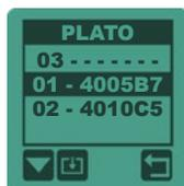
Para apagar el LED del plato y los auriculares inalámbricos durante el uso: en OPCIÓN > PLATO vinculado, seleccione el plato de su elección como se muestra en la pantalla y pulse la tecla **+** durante 4 segundos. Cuando se apaga, este modo se desactiva y el LED vuelve al funcionamiento normal.
