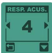
La Respuesta acústica le permite amplificar el volumen de objetivos profundos. Da la impresión de mayor potencia, pero no proporciona ninguna profundidad adicional ya que esta configuración solo afecta a la curva de sonido (el rango dinámico de sonidos). Los Niveles de respuesta de audio más bajos dan una buena percepción de profundidad.
