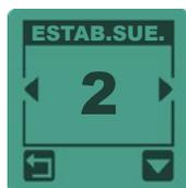
Esta configuración se puede ajustar de 1 a 3 y se utiliza para definir el nivel de inestabilidad/retroalimentación del suelo que quiere tolerar.
