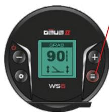
Desde cualquier menú, puede calibrar el efecto del suelo en cualquier momento manteniendo pulsada la tecla mientras bombea el plato en el suelo hasta que la señal de audio del suelo se atenúe y el valor se estabilice.
