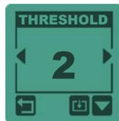
Esta función se utiliza para establecer la amplitud del umbral del sonido de fondo. Threshold se silenciará al pasar por encima de los objetivos rechazados.
