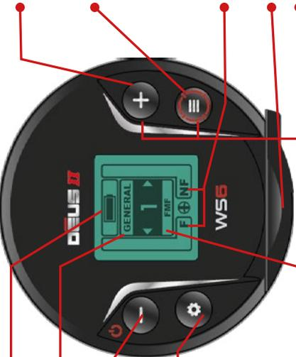
Alterna el nivel de carga del plato y WS6
