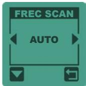
Esta función activa un escaneo automático de las frecuencias de detección e indica un canal despejado con la menor interferencia en cada cambio de programa o cada cambio de frecuencia en el programa MOND. El escaneo de frecuencia es particularmente rápido en el **DEUS II**, sin embargo ralentizará su navegación en 2 segundos al cambiar de programa.
