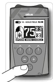
El programa **10 GOLD FIELD** es especialmente adecuado para la búsqueda de oro nativo (pepitas) en suelos mineralizados o en zonas de oro probable. Estas zonas suelen ser muy difíciles de detectar por los detectores convencionales, debido a la presencia de minerales ferromagnéticos (ferritas) que enmascaran las pepitas de oro. El programa n°10 GOLD FIELD utiliza una estrategia de detección diferente que los detectores clásicos, permitiendo una mejor detección de pepitas en suelos mineralizados.
