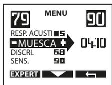
Muesca (Notch) es un complemento a la discriminación, permite rechazar objetivos específicos mientras que la discriminación rechaza todos los objetivos por debajo de un rango, por ejemplo, si observa un objetivo repetitivo no deseado en el campo, puede optar por rechazar sólo ese valor de conductividad y seguir aceptando los valores de conductividad más altos y más bajos de otros objetivos.
