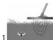
Coloque el plato a una distancia aproximada de 2 a 5 cm del suelo y alejado del objetivo a detectar. Luego pulse  $\odot$  para calibrar el umbral.
