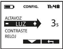
El control remoto tiene una función de luz de fondo. Aquí puede definir la duración de la luz de fondo en segundos
